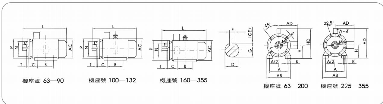
機座帶底腳，端蓋上有凸緣(帶通孔)的電動機
