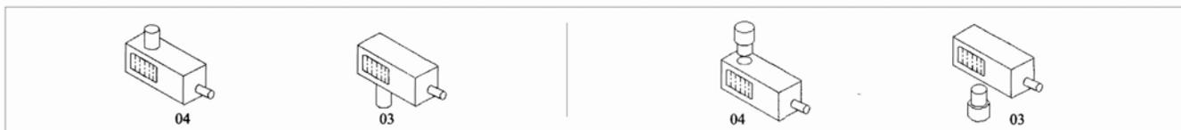
2 级斜齿轮减速器竖立安装
