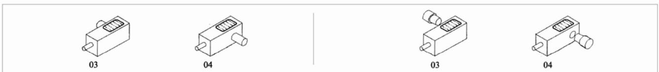
2 级斜齿轮减速器垂直安装
