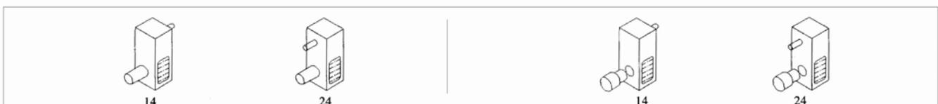
3 级斜齿轮减速器竖立安装
